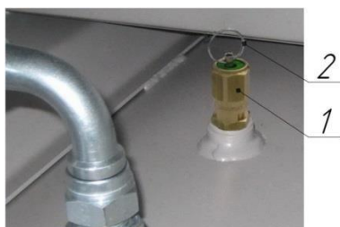
Рисунок 9 – Клапан предохранительный пружинного типа
