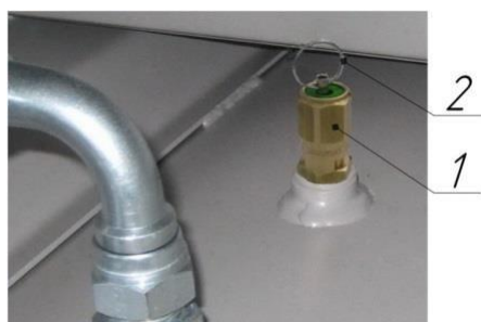
Рисунок 11 – Клапан предохранительный пружинного типа
